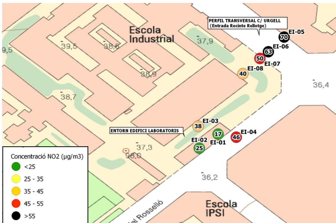
Figura 4. Ubicación de los captadores (EI-01 a EI-08). Se muestra la concentración media de NO 2 expresada en µg/m 3 durante el período de medida del 14.11.2019 al 05.12.2019.
