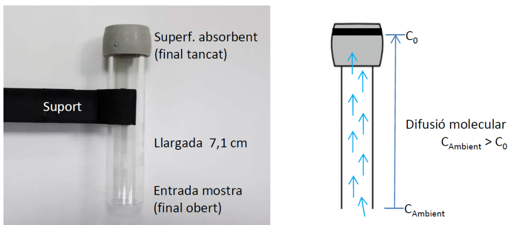
Figura 1. Principio de funcionamiento de los captadores pasivos de difusión de \text{NO}_2 de tipo Palmes, donde C_{\text{Ambient}} es la concentración de la muestra ambiente y C_0 es la concentración en la superficie del absorbente.
